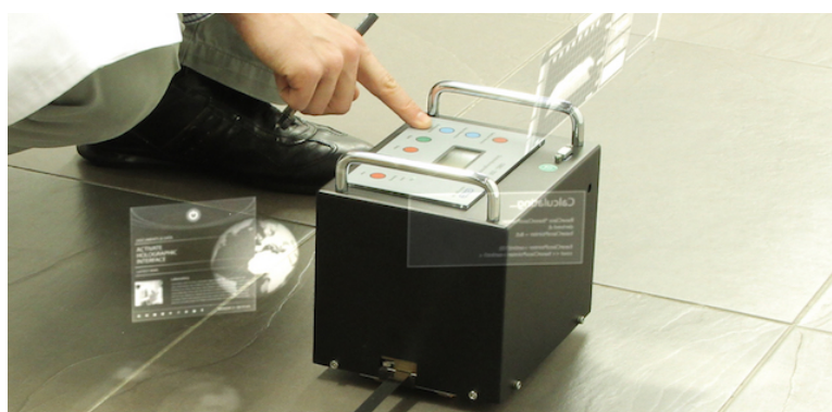
Determinación de la resistencia al deslizamiento para superficies con tránsito calzado conforme norma DIN 51131:2014-02
