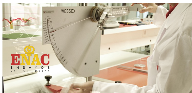
Resistencia al deslizamiento/resbalamiento de los pavimentos sin pulir (USRV) conforme Norma UNE-ENV 12633:2003 Anexo A
