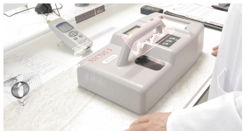
Coeficiente de fricción conforme Norma ISO/DIS 10545-17 (TORTUS)
