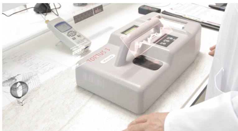
Coefficiente de fricción conforme Norma ISO/DIS 10545-17 (TORTUS)
