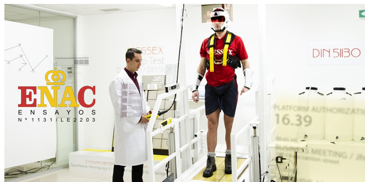
Ángulo crítico deslizamiento de pavimentos para locales de trabajo y zonas de trabajo con riesgo de resbalamiento conforme Norma DIN 51130:2010 Apdo. 5
