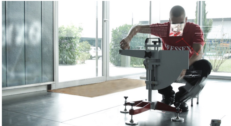
Coefficiente de resistencia al deslizamiento según norma de ensayo NLT-175/73 PENDULO del Laboratorio del Transporte y Mecánica del Suelo " José Luis Escario
