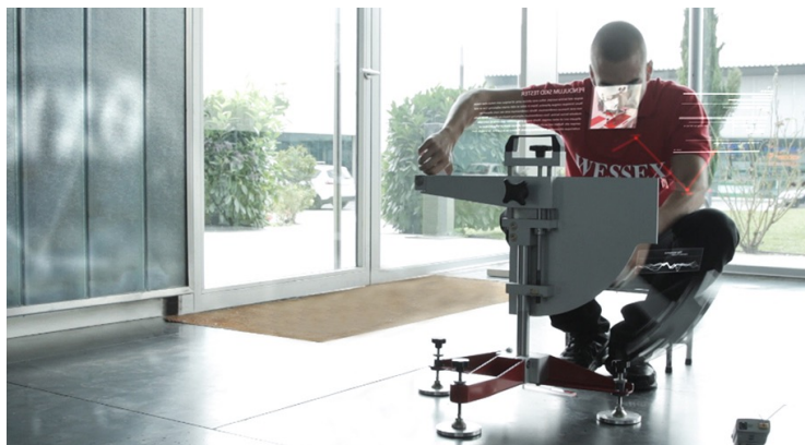
Resistencia al deslizamiento/resbalamiento de los pavimentos sin pulir (USRV) conforme Procedimiento Interno MF-01
