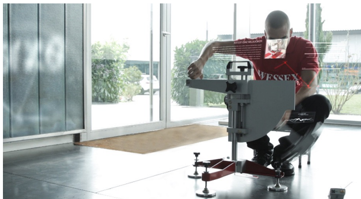
Ensayo Resistencia al deslizamiento de los pavimentos sin pulir (USRV) conforme Procedimiento Ensayo en seco DB-SUA / 3 marzo 2014 CTE
