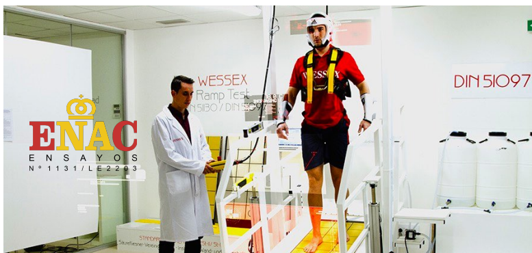
Ángulo crítico deslizamiento de pavimentos para zonas húmedas de andar descalzo conforme Norma DIN 51097:1992
